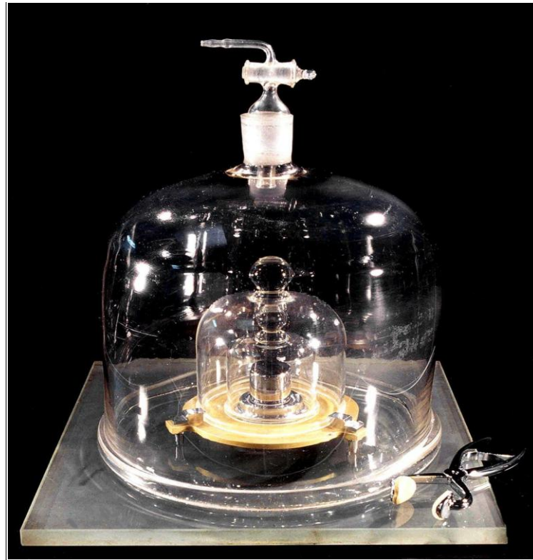
شكل رقم (10) [8] (الكيلوغرام الكبير Le Grand K)
